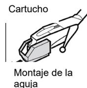
Antes de usar, retire el Montaje de la aguja de plástico blanco tirando de él directamente de la parte delantera del Cartucho como indica la flecha.
