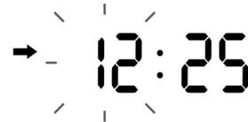
**Nota:** El INDICADOR PM (#10) se encuentra en la parte superior izquierda de la pantalla. El INDICADOR PM (#10) se iluminará cuando los dígitos de la hora seleccionados sean para la hora PM. El INDICADOR PM (#10) se apagará cuando los dígitos de la hora seleccionados sean para la hora AM.
